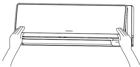
• 手持面板两侧（面框圆凹处）将其打开。
