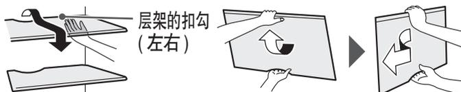
安装时，把层架插放到最内侧之后，把层架内侧稍微抬高并推进去。
