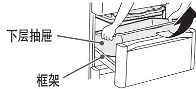
安装下层抽屉时，请将下层抽屉左右突出的部分向门框两旁的洞插入固定。
