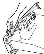
若真空冰温密封垫安装沟槽中有脏污，请擦拭干净。
