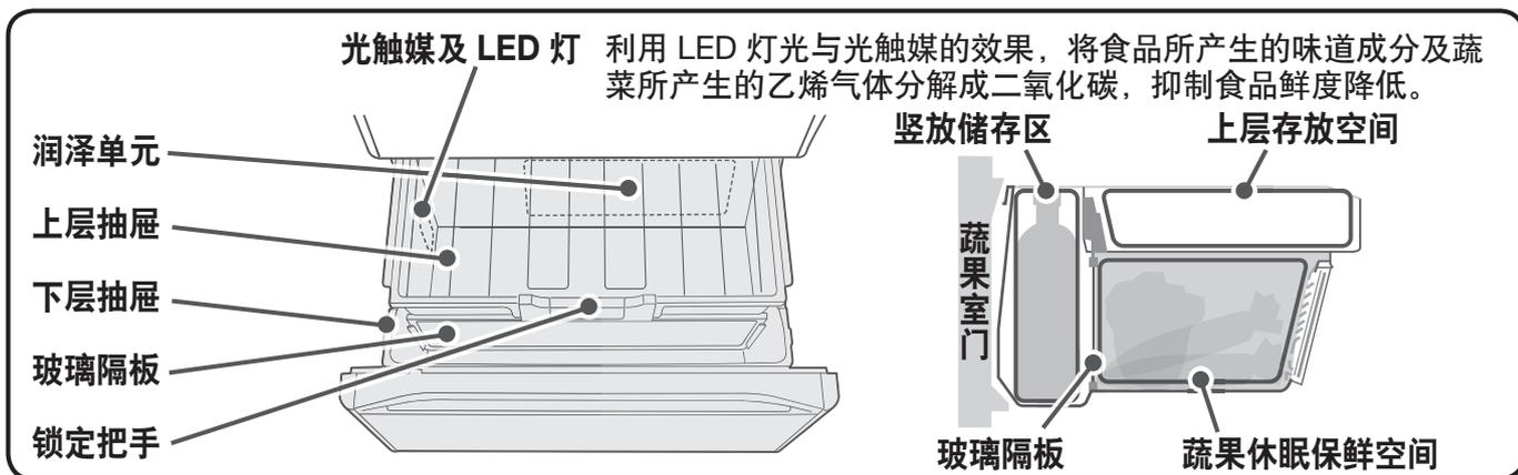
**光触媒及 LED 灯** 利用 LED 灯光与光触媒的效果，将食品所产生的味道成分及蔬菜所产生的乙烯气体分解成二氧化碳，抑制食品鲜度降低。
