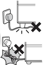
在已受损的状态下使用时，会有引起触电、短路、火灾的危险。
