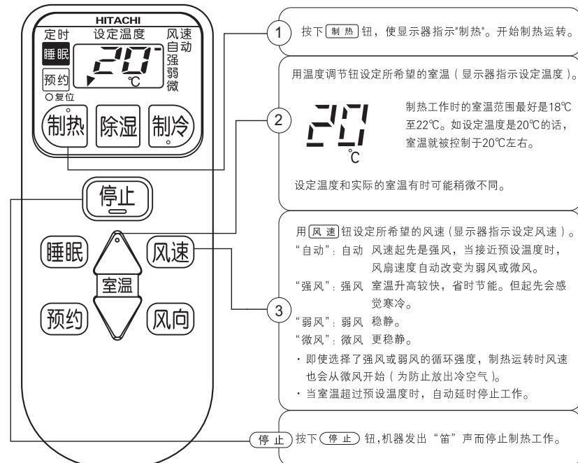
■ 各项设定状态全被存储于遥控器的存储中, 所以下次操作机器时只要按下(制热)钮即可。
