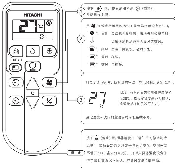
■ 各项设定状态全被存储于遥控器的存储中，所以下次操作机器时只要按下 (制冷) 钮即可。
