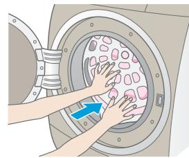
3 将洗涤盖外侧朝自身方向拉靠至滚筒内侧
