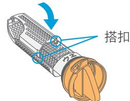
维护保养过程中线屑滤网盖脱落时
