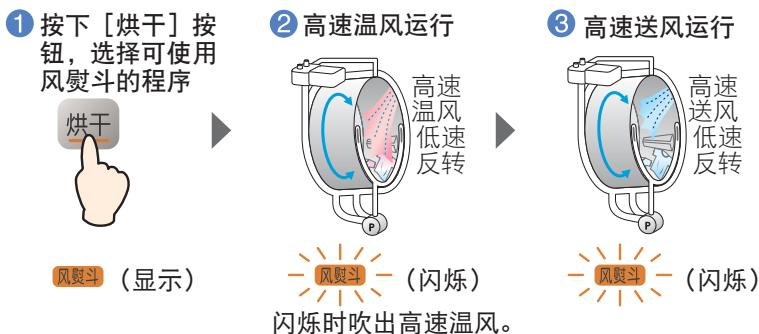
●烘干滤网堵塞，机体内部的压力上升时，【风熨斗】有可能不进行闪烁，保持原来的显示（低速温风运行）。
