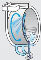
通过循环泵将洗涤液喷洒到洗涤物上。
