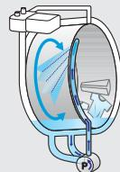
一边旋转滚筒，一边使水循环，从而分离出残留的洗涤剂。
