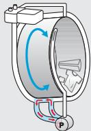
使用循环泵让洗涤液在滚筒底部循环，从而溶解洗涤剂。
