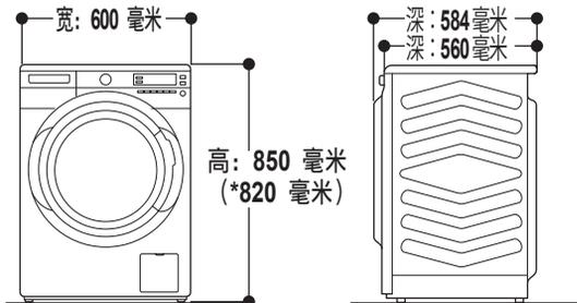
(\*适合台面下安装、不带操作台的高度)
