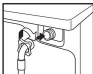
将进水管连接到洗衣机背板上。
