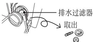
6. 按相反的顺序将盖子、排水过滤器和过滤器盖归位。
