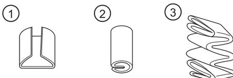
■ 将洗涤物放入滚筒中，使洗涤物的末端朝向滚筒后侧。
