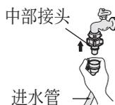
• 若要使进水管脱离中部接头，请关闭水龙头，然后拉下进水软管，并推下导板。
