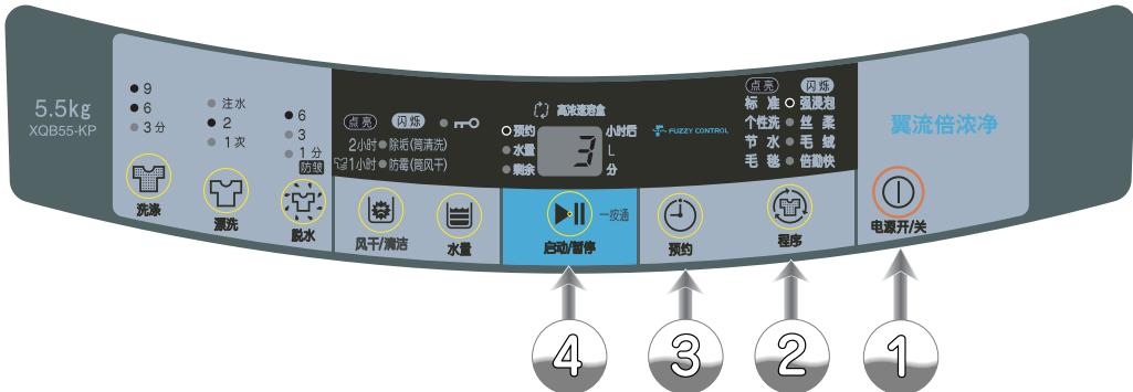
1 放入洗涤物，关闭机盖，按下电源开关按钮 ①
