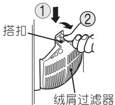
**4 将网袋角孔套进外壳凸部，然后对好左右两边搭扣。(将网袋的角孔突起部分推进外壳内部)**
