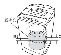
**■ 底板的安装(底板安放在洗衣机顶部的发泡上)**
