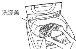
将洗涤盖的凹部嵌入洗涤筒的凸部并压放平整。
