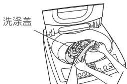
将洗涤盖的凹部嵌入洗涤筒的凸部并压放平整。
