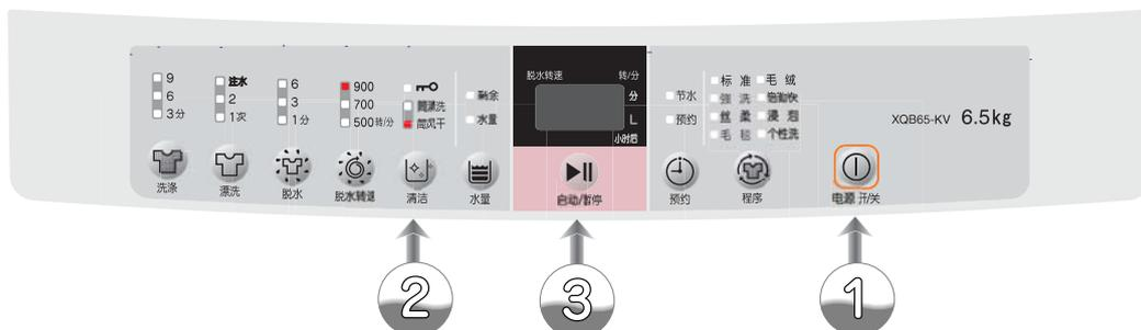
1 先打开吸气窗，再按下电源按钮
