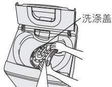
将洗涤盖的凹部嵌入洗涤筒的凸部并压放平整。
