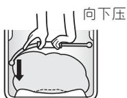
**2** 如图抓住中圈，将洗涤盖向箭头方向弯曲。
